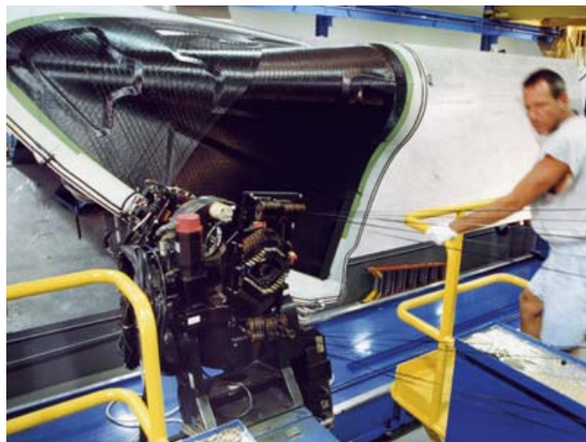
Kuva 4. Automatisoitu tape-layup -kone valmistaa C-17 -rahtikoneen laskutelinealuukua [ http://www.aerospace.gknplc.com/imagelibrary.aspx ].
