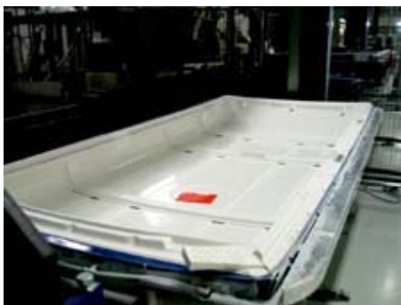
Kuva 6. Volkswagen Transporterin korkea katto pitkälti automatisoidulla RTM-prosessilla kertamuovikomposiitista valmistettuna [composites news].
