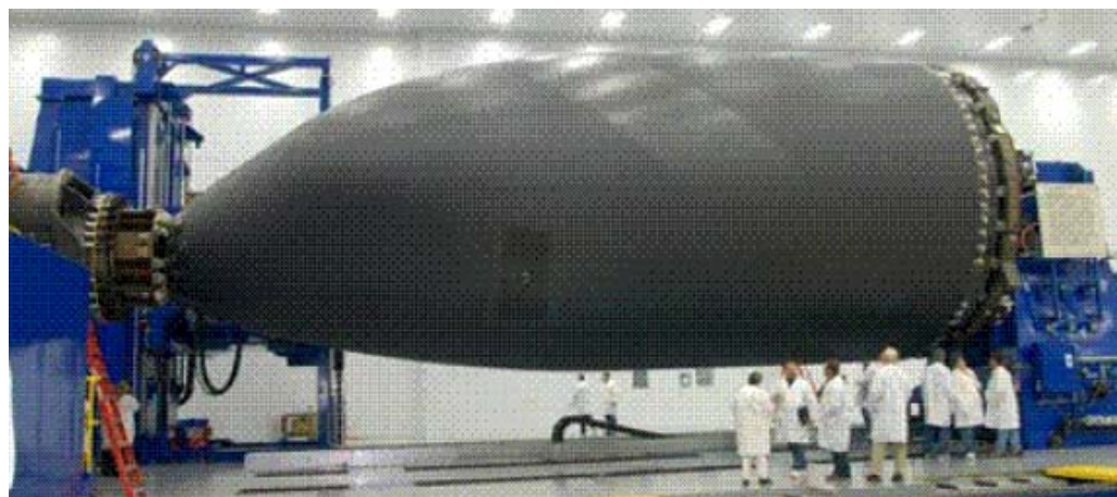
Kuva 5. Boeing 787 -matkustajakoneen eturunko valmistettuna yhtenä kappaleena urosmuotin päälle "fiber placement"-tekniikalla.
