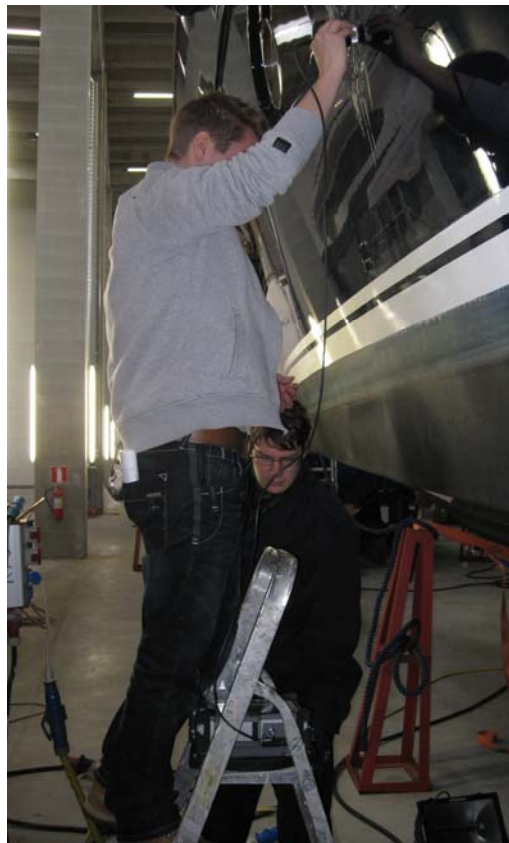
Kuva 7. Olympus Epoch 1000 ja komposiittiluotain kokeilussa iskuvaurioon Kotka Yachtstorella.
