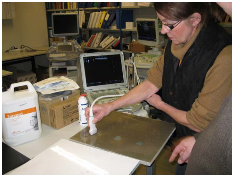
Kuva 6. Sairaaloissa käytetyn ultraäänilaitteen testaus delaminaatiovaurioitettulle 20mm umpilaminaatille.
