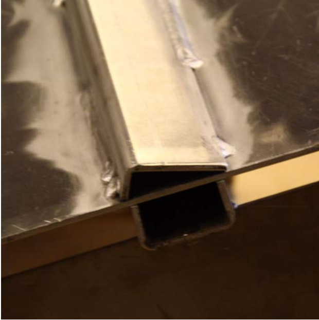
Kuva 18. Veneen pohjaan tulevat L-profiilit ja niiden vastapuolella olevat U-profiilit.
