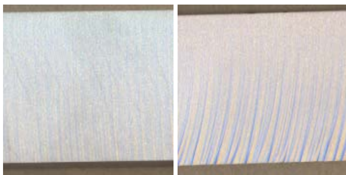
Kuva 10. Taulukkoon 4 liittyvät leikkausjäljet. Vasemmalla laatu 5, oikealla laatu 3 (Accustream waterjet products)
