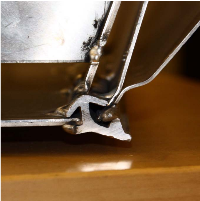
Kuva 17. Pohjalevyn ja reunan kotelolevyjen hitsaus pursoteprofiilin avulla.
