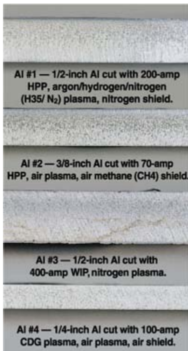
Kuva 13. Plasmaleikkauksen leikkausjälkiä vertailtuna erilaisilla kaasuilla ja virroilla 6061-alumiinille. (Hackett 2001)
