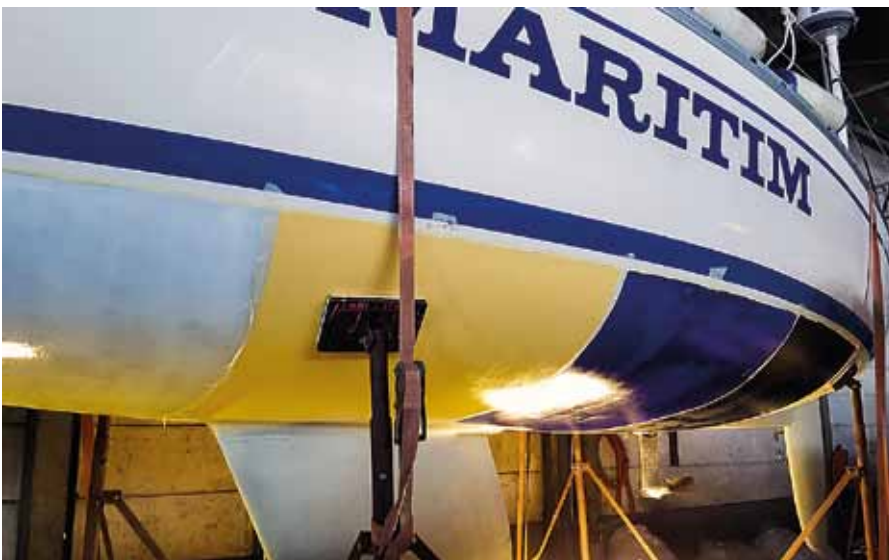
Purjeveneen pohja maalattiin viidellä erilaisella eliönestomaalilla.
