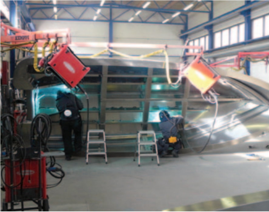
Alumiinirungon hitsausta Campnoun tehtaalla Ähtärissä.
