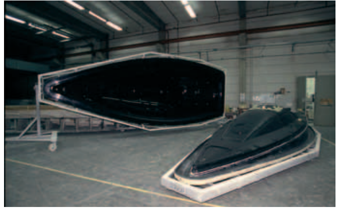
Tulevaisuuden venevalmistusta suljetuissa muoteissa alipaineinjeksiota käyttäen.
