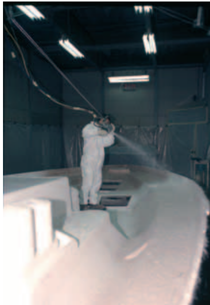
Ruiskulaminoinnin yhteydessä ruiskujen ja rovingisyöttöjen maadoitus on syytä tarkastaa.
