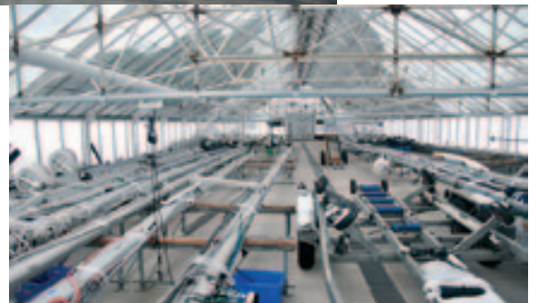
Gripmarineessa purjeverneiden takilat on varastoitu entiseen kasvihuoneeseen. Tila antaa mainiot mahdollisuudet mastojen ja puomien huoltoon.
