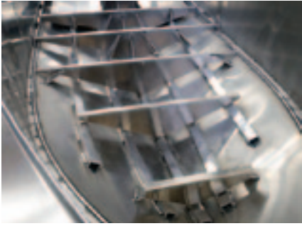
Vene-ohjelmassa kehitettiin ja käyttöönotettiin Silver AluFibre -veneiden valmistukseen hitsauksen vaiheinen jigi-kokonaisuus
