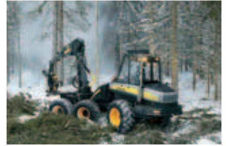
Telvan maahantuomia 150–200 kW Mercedes Benz -dieselmoottoreita käytetään Ponssen metsäkoneissa. Kuva Ponsse Oyj
