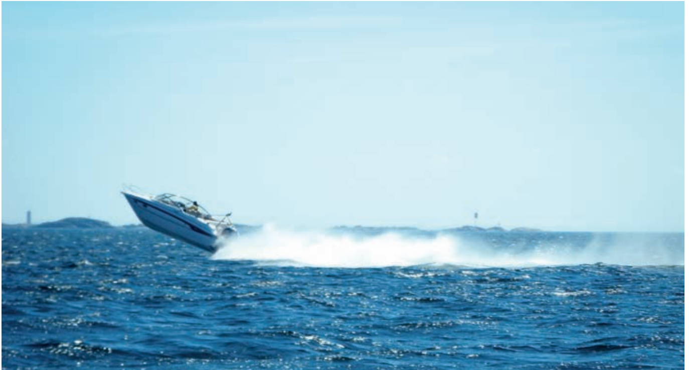
Peräpeili-tutkimushankkeessa mitattiin perämootorista veneen peräpeiliin kohdistuvia maksimikuormia täysmittakaavakokeiden avulla ja luotiin menetelmä kuormien ennustamiseksi.
