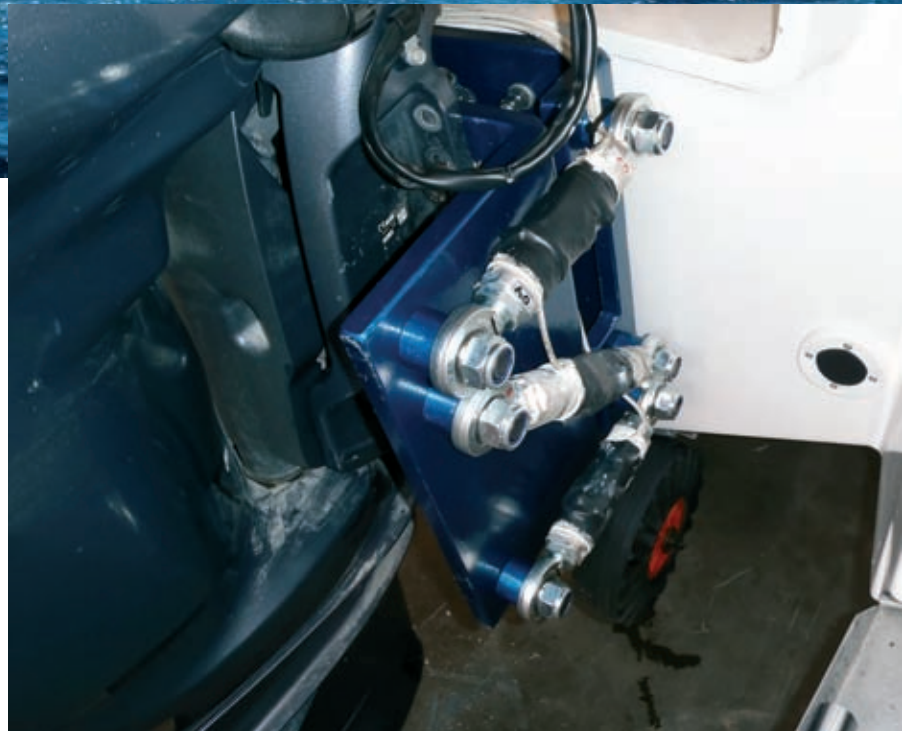
Peräpeili-tutkimushankkeessa mitattiin perämootorista veneen peräpeiliin kohdistuvia maksimikuormia täysmittakaavakokeiden avulla ja luotiin menetelmä kuormien ennustamiseksi.
