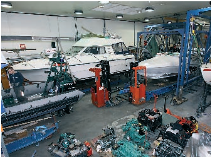
Huolto- ja asennushalliin mahtuu useita veneitä ja hallissa on 1000 kg:n katonosturi moottoriasennuksiin tai kannen irrottamiseen.
