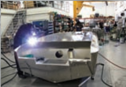
Faster 525 CC kootaan hitsaamalla Juha Snell Oy:n tehtaalla Kellokoskella.
