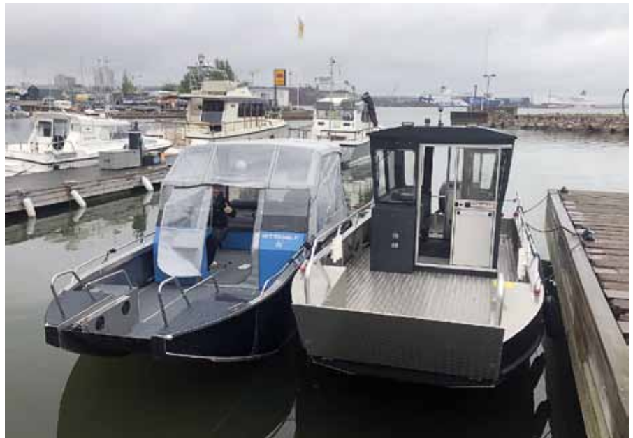
Viranomaisveneitä uudessa varusteluhal- lissa. Pelastuslaitokselle tehty Alucat W14 on varustettu hydraulisella keularampilla ja tasaiselle kannelle on asennettu nostolaite.
