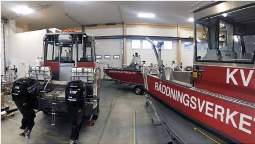
Viranomaisveneitä uudessa varusteluhal- lissa. Pelastuslaitokselle tehty Alucat W14 on varustettu hydraulisella keularampilla ja tasaiselle kannelle on asennettu nostolaite.
