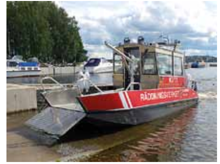
Viranomaisveneitä uudessa varusteluhal- lissa. Pelastuslaitokselle tehty Alucat W14 on varustettu hydraulisella keularampilla ja tasaiselle kannelle on asennettu nostolaite.
