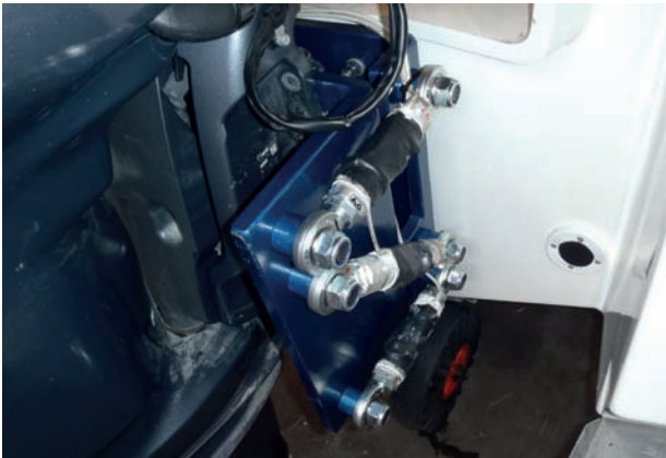
Kuva 1. Monikomponenttivaaka peräpeilin ja perämoottorin välissä.
