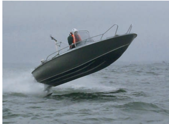
Kuva 2. Maksimikuormat haettiin hypyistä aallokossa.
