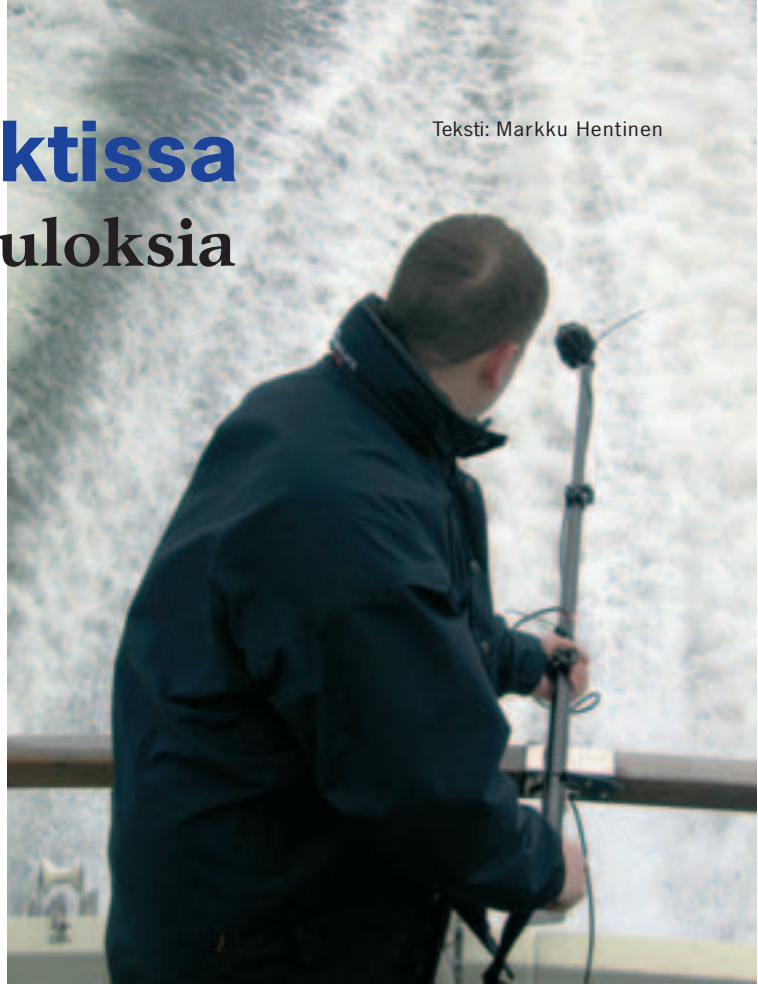
Kuva 1: Äänitason mittausta peräpeilin takaa
