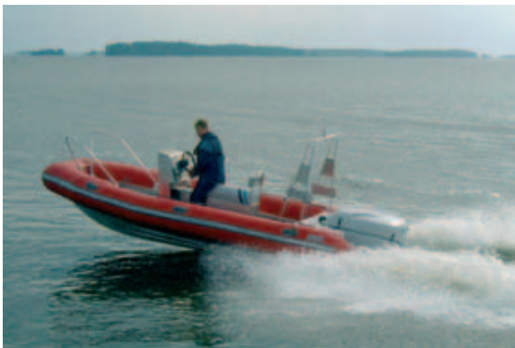
Kuvassa alumiini-pohjainen INTER 565 RIB -kumivene, jossa on OPS JetPac 150 hv moottori.
