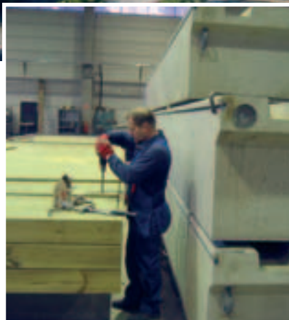
Raskasponttooneja valmistuu Marinetekin uudessa tehtaassa Vantaan Kuninkaanmäessä. Menossa on puukannen asennus betoniponttoonin päälle.
