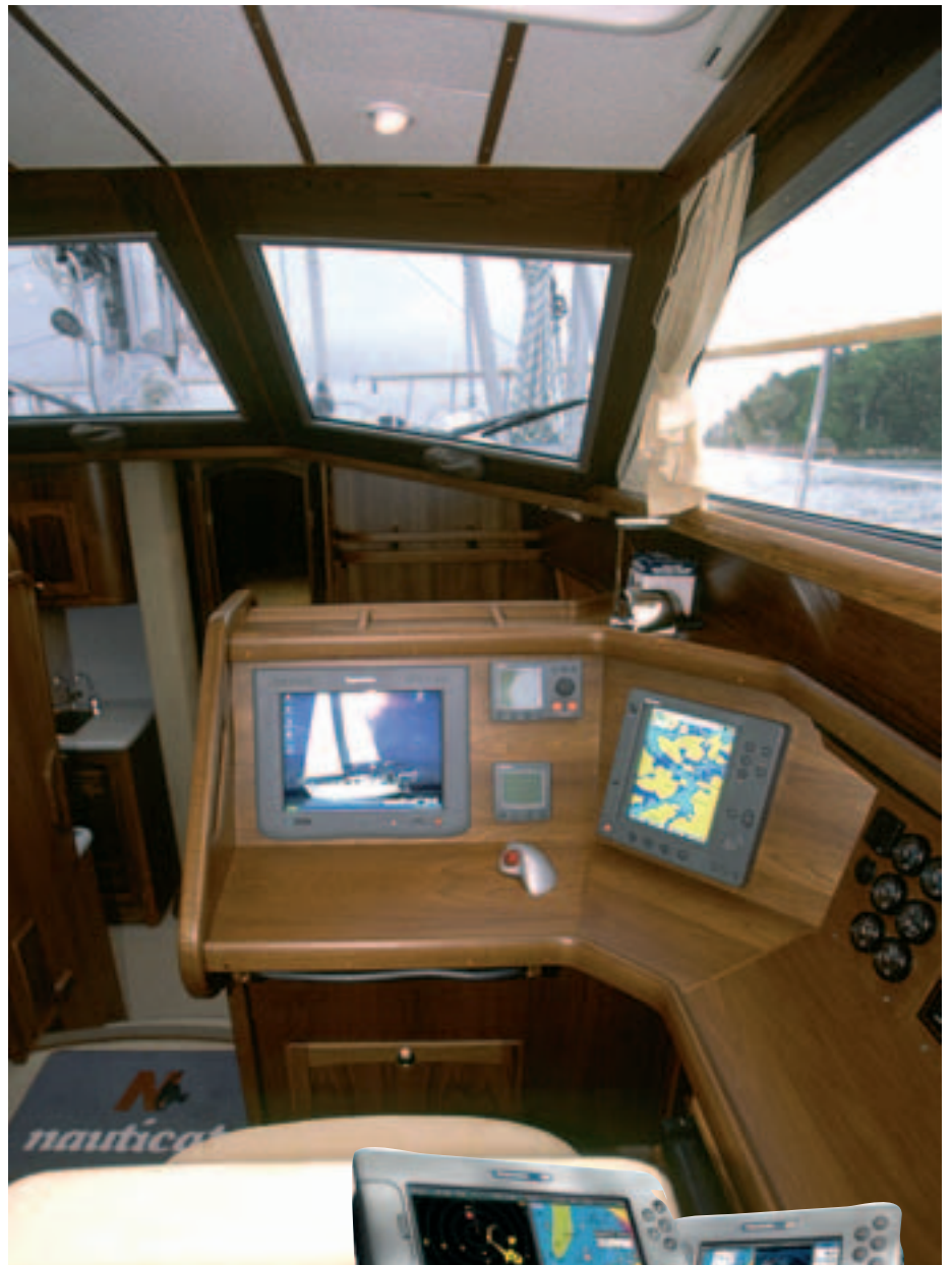
Raymarinen monitori ja karttaplotteri Nauticat 515 -purrassa. Plotteriin on liitetty myös tutkanäyttö. Oikealla uudet E Series -monitoimilaitteet.
