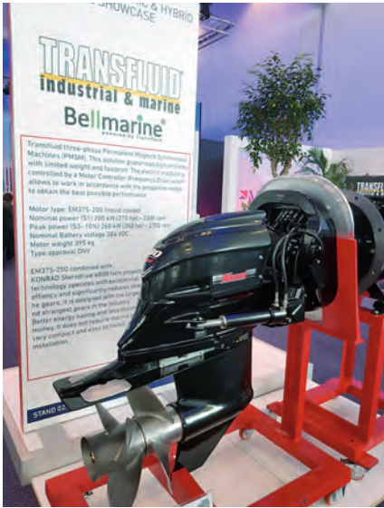
Transfluidin 200 kW moottori yhdistettynä Konradin vetolaitteeseen. Akkujännite on 384 V.
